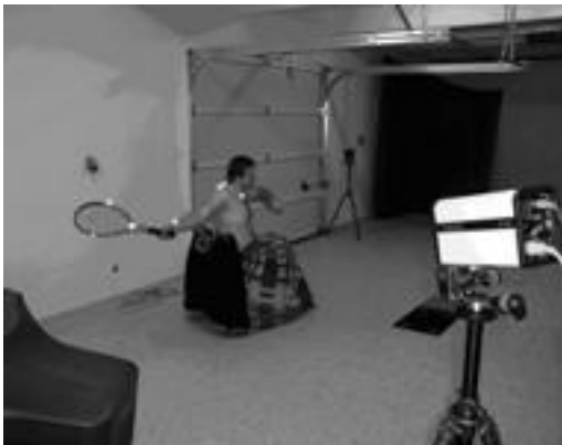
KINEMATIKA a DYNAMIKA – technologie QUALYSIS - 3D kinematická a dynamická analýza pohybových úloh u osob se specifickými potřebami.
